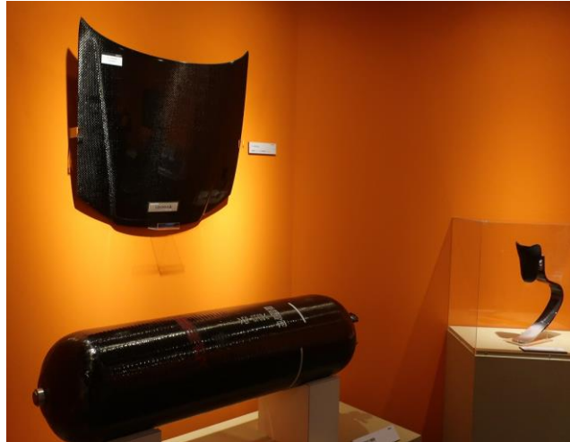
右 先端素材としての炭素繊維 自動車ボディ、水素貯蔵タンク、義肢
