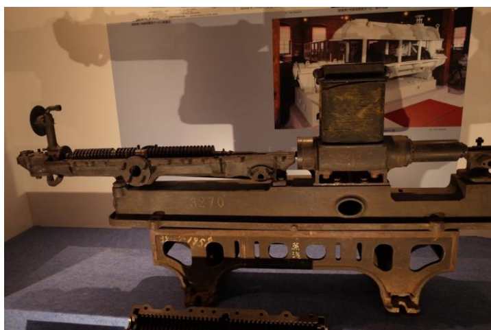
右 蒸気タービンの原型のひとつパーソンズタービン (東京工業大学蔵)
