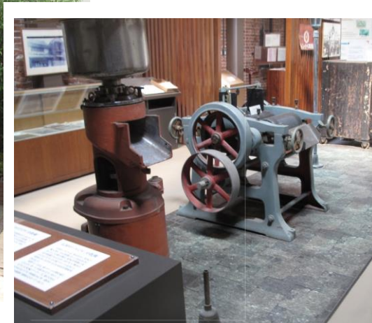
左 コロイドミル、右 石材ロールミル 顔料の粉碎、分散に各種の装置が使われました。
